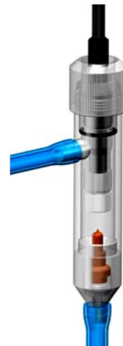
Рис. 3.7. Фиксация АСрН 2 в измерительной камере.
