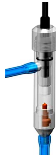
Рис. 3.7. Фиксация АСрН 2 в измерительной камере.
