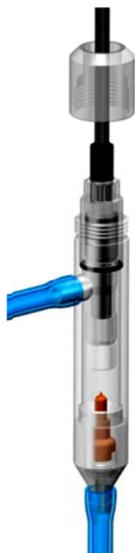
Рис. 3.6. Установка АСрН 2 в измерительную камеру.
