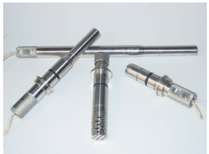
Рис. 3.6. Внешний вид стерилизуемых амперометрических сенсоров ACSrO 2 -06.
