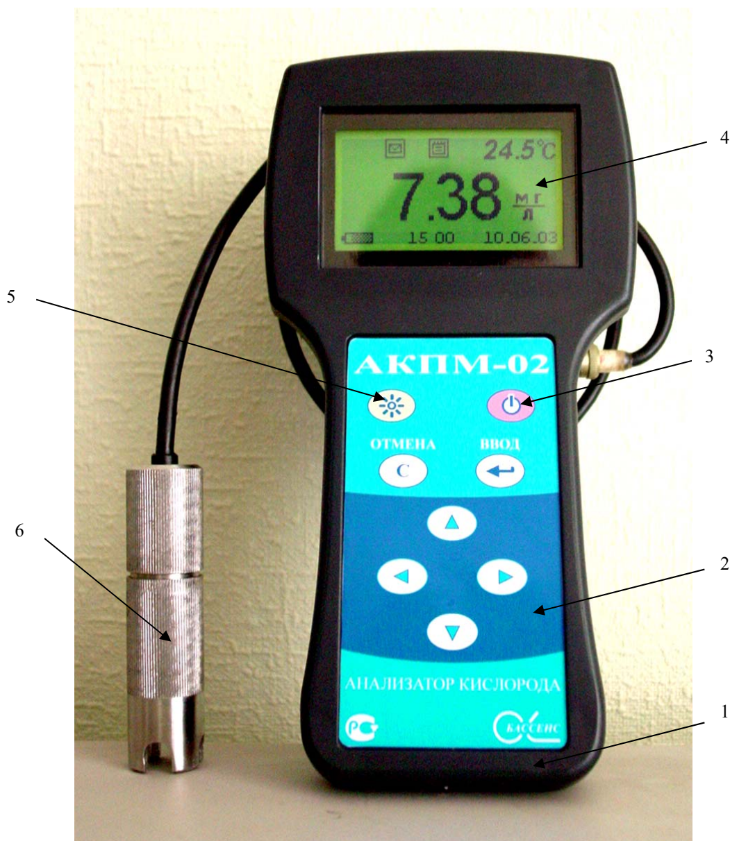
Рис. 4.1. Внешний вид анализатора кислорода АКПМ-1-12.
