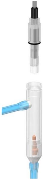
Рис. 3.9. Установка АСрО 2 в измерительную камеру
