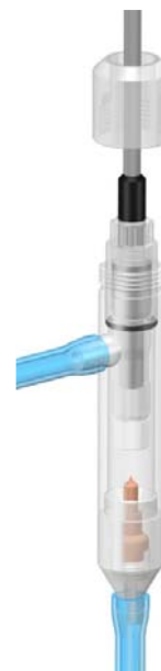
Рис. 2.5. Фиксация АСрО 2 в измерительной камере
