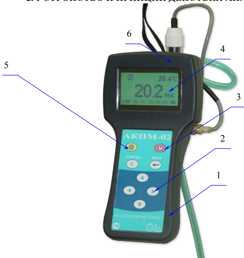
Рис. 2.1. Внешний вид анализатора кислорода АКПМ-1-02 (лицевая сторона).
