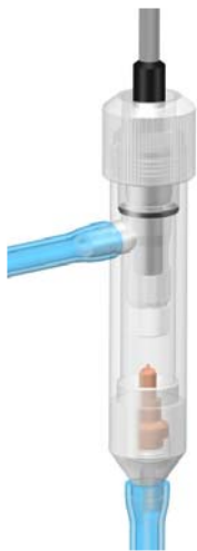
Рис. 2.1.1. Внешний вид сенсора в измерительной камере
