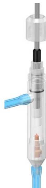
Рис. 2.1.2. Фиксация ASrO_2 в измерительной камере.
