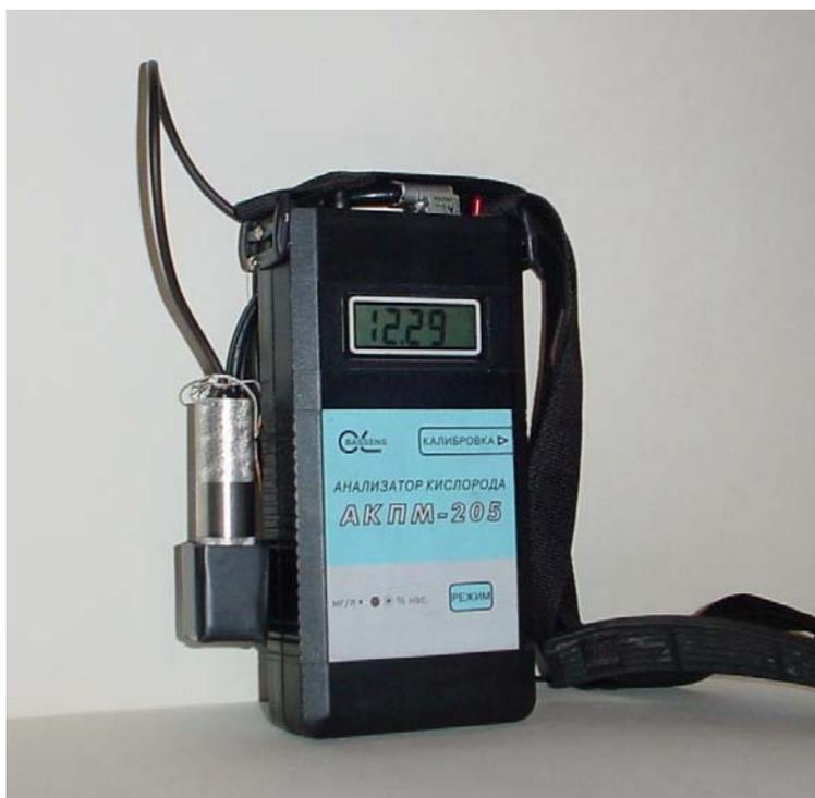
Рис. 1. Внешний вид анализатора кислорода АКПМ-02-05
