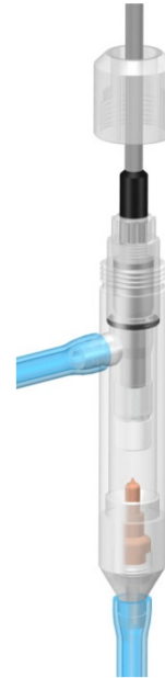
Рис. 3.10. Фиксация АСрО 2 в измерительной камере
