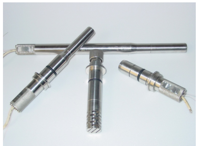
Рис. 3.6. Внешний вид стерилизуемых амперометрических сенсоров ACSrO 2 -06.
