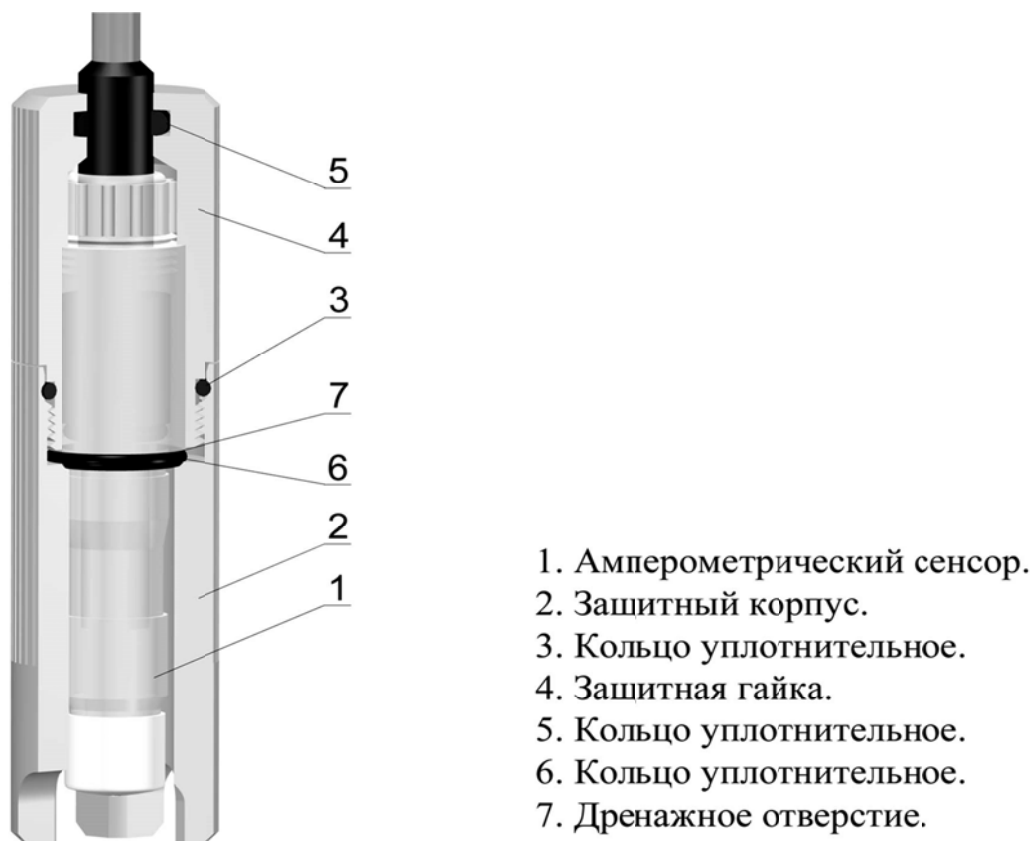
Рис. 4.3. Внешний вид АСрО 2 -05 погружного типа.
