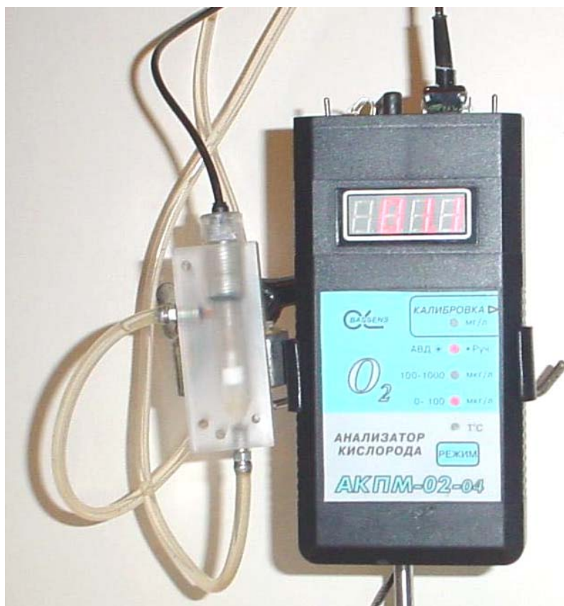
Рис. 1. Внешний вид анализатора кислорода АКПМ-02-04
